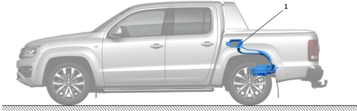
Abb.4: Befüllöffnung des AdBlue® Tanks
