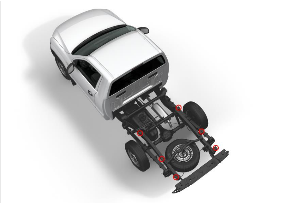
Abb.2: Amarok Single Cab – Aufnahmekonsolen Cargobox (rote Markierung!) hier Prinzipdarstellung.
