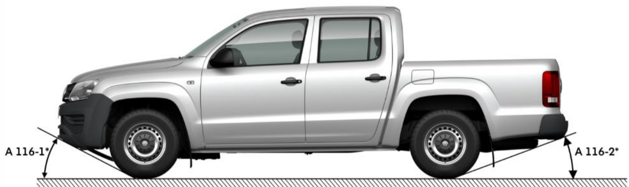
Abb. 1 Überhangwinkel Amarok-DC (Double-Cab)
