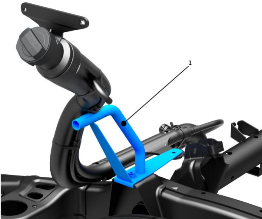
Abb.2: Transportstütze für das Tankeinfüllrohr (Amarok ohne SCR-System)
