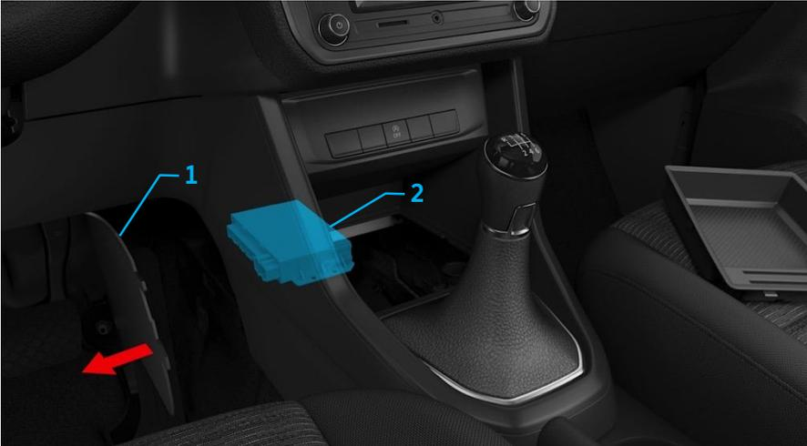
Abb. 4: Elektrische Schnittstelle für Sonderfahrzeuge (PR-Nr. IS1)
