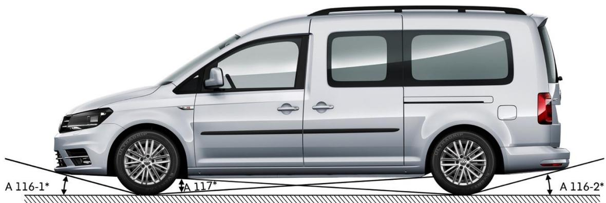
Abb. 2: Überhang- und Rampenwinkel Caddy Maxi
