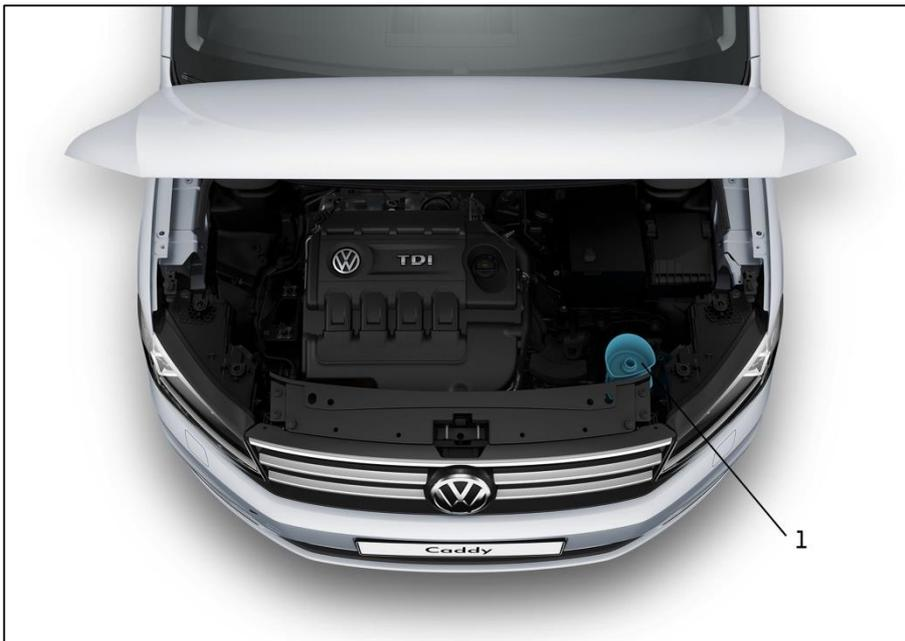
Abb.2 Befüllöffnung des AdBlue® Tanks im Motorraum
