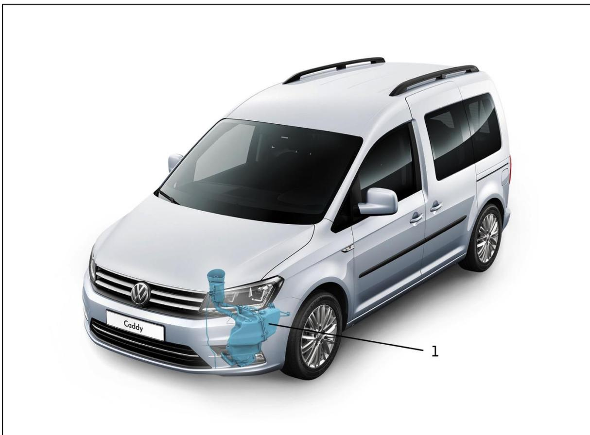
Abb.1 Einbaulage des AdBlue-Tanks im Fahrzeug
