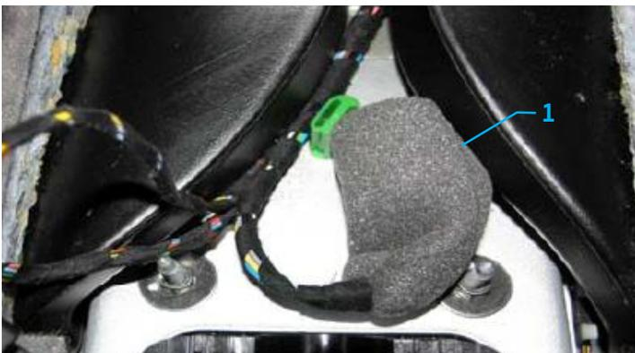
Abb. 3: Elektrische Schnittstelle für Sonderfahrzeuge, Ansicht R ( PR-Nr. IS1/UE1-Leitung, 2K5.970.372)
