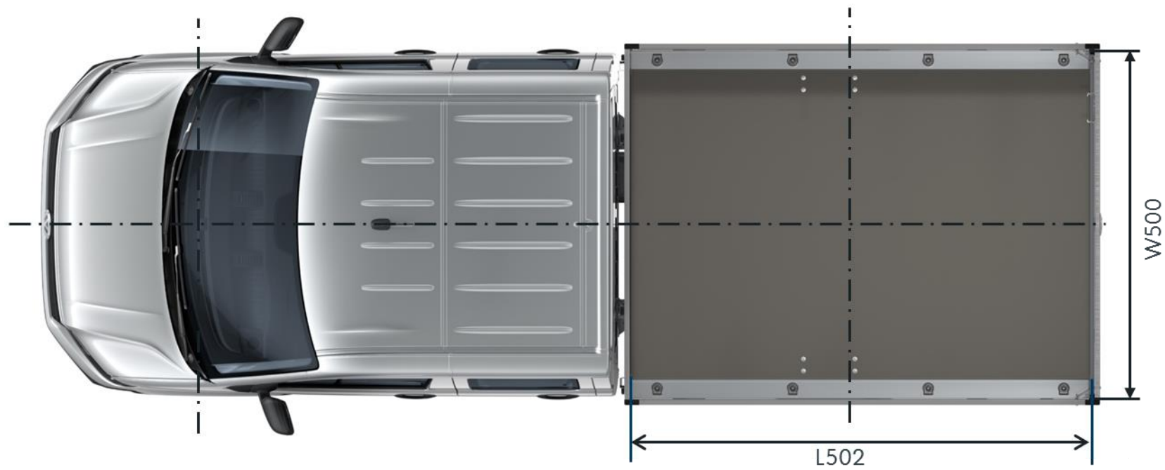
Abb 2.: Fahrzeugmaße Doka – Pritschenwagen/Dachansicht
