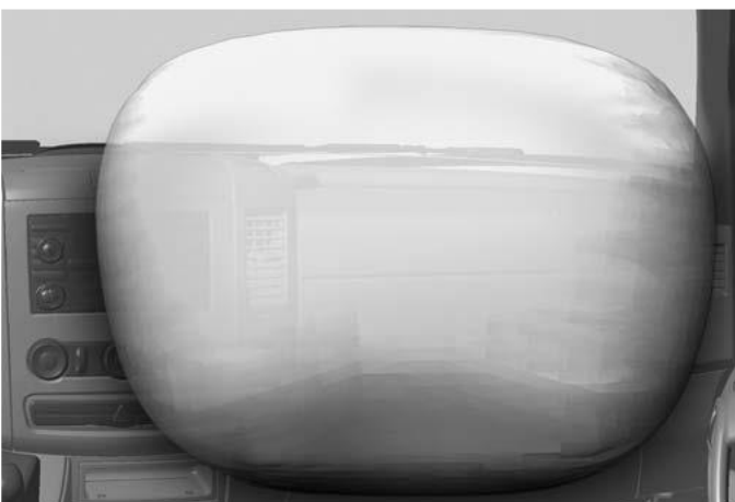
Entfaltungsbereich Beifahrerairbag (Bilder in Bearbeitung!)
