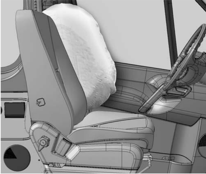
Entfaltungsbereich Thoraxbag Fahrzeug links (Prinzipdarstellung)
