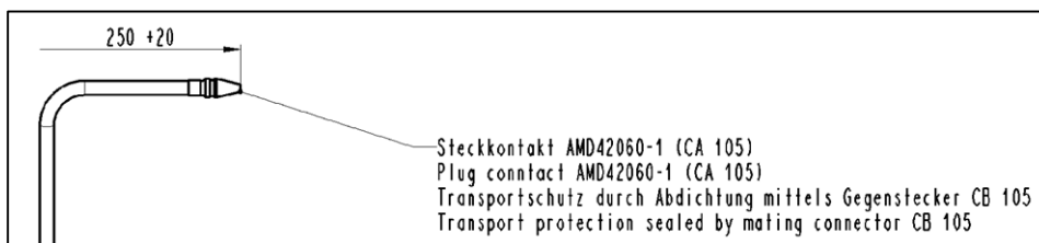
Elektrische Verbindung, Steckkontakt AMD42060-1 (CA 105)
