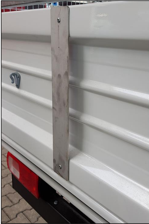
Abb.3: Streifblech an Pritschenwand hinten
