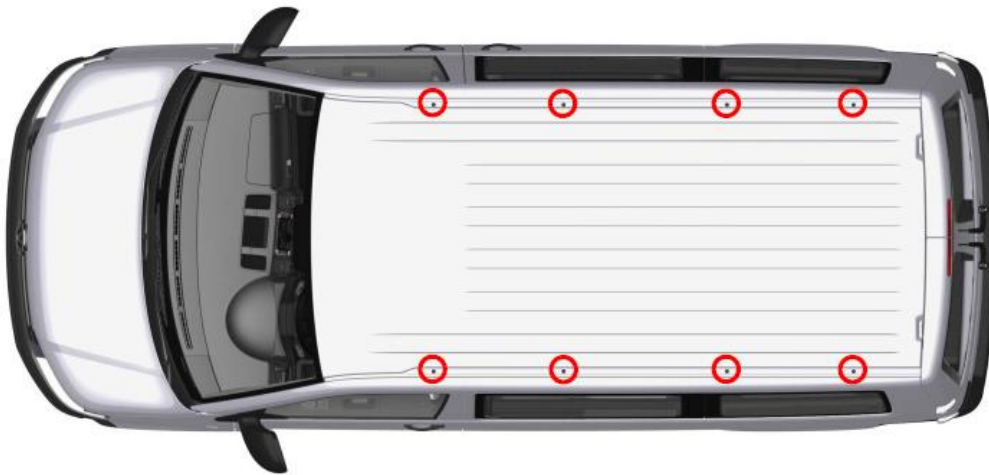
Abb.1: Serienmäßige Dachbefestigungspunkte Kastenwagen und Kombi (kurzer Radstand)
