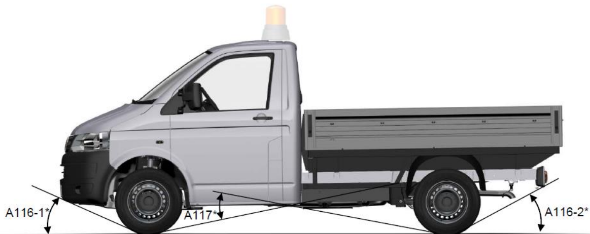
Abb. 2 Überhang- und Rampenwinkel Transporter Pritsche/Fahrgestell
