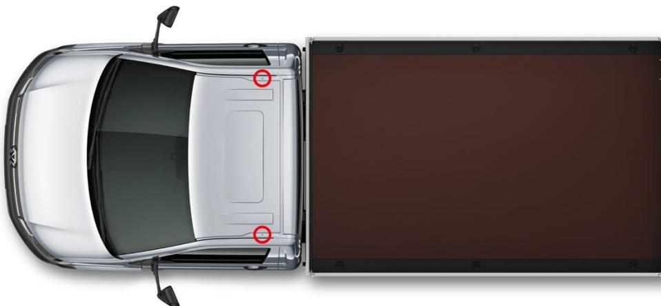
Abb.3: Serienmäßige Dachbefestigungspunkte Einzelkabine
