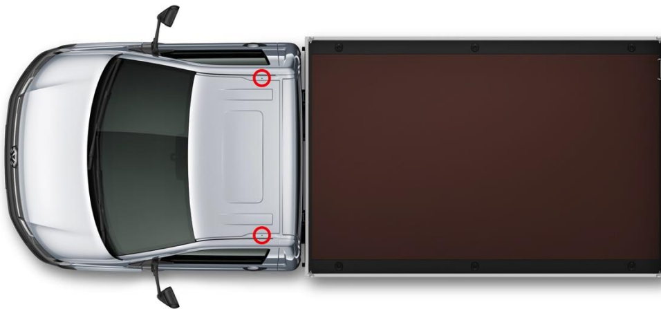
Fig. 3 : points de fixation de série sur le pavillon de la Simple Cabine
