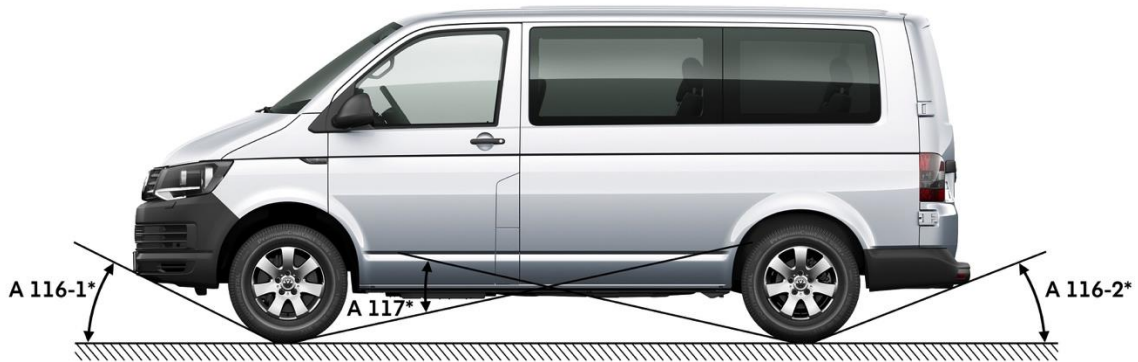
Fig. 1 Angle d'attaque / de fuite et angle de crête du fourgon tôlé/fourgon vitré Transporter
